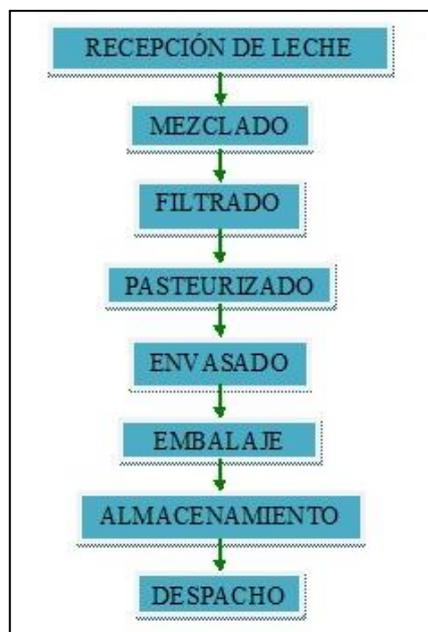
**Ilustración 6-5:** Proceso de producción de la leche pasteurizada
