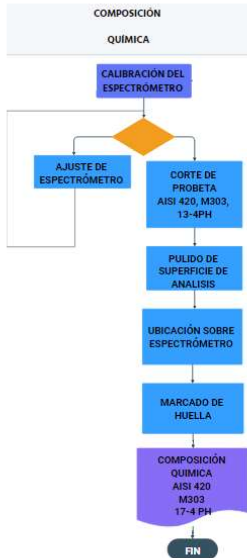
Ilustración 1-3: Procedimiento de ensayo de espectrometría
