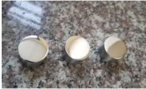
Ilustración 4-4: Probetas con superficie tipo espejo
