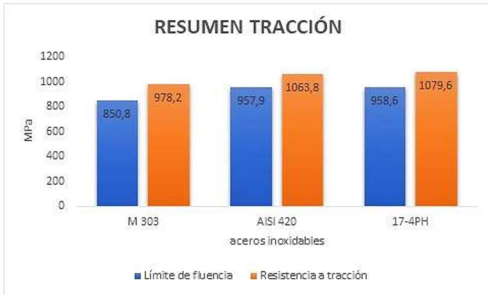
Ilustración 20-4: Representación del límite de fluencia y resistencia a la tracción de cada material.
