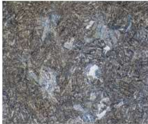
Ilustración 16-2: Microestructura de la Bainita
