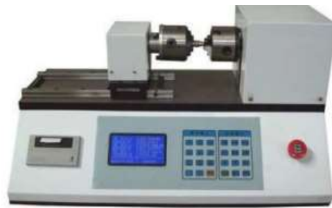
Ilustración 22-2: Máquina de ensayos de Torsión serie NJS-Z
