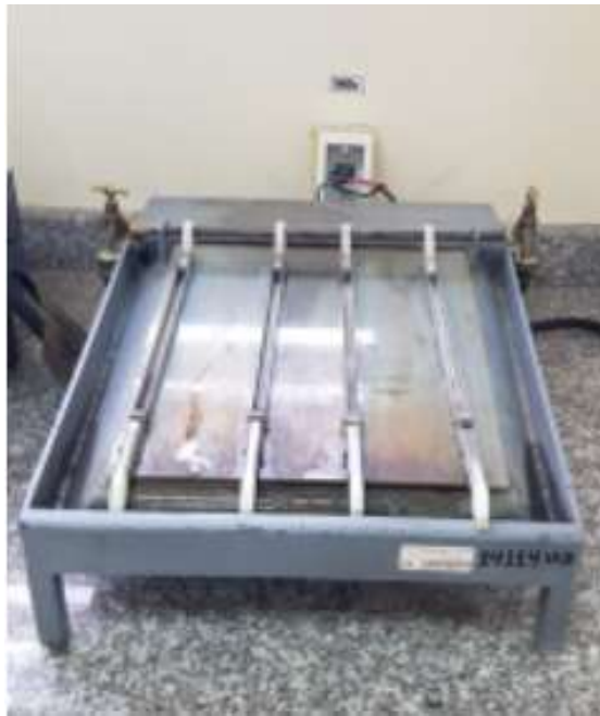
Ilustración 3-2: Banco para desbaste de probetas
