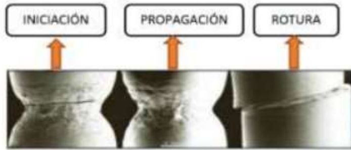
Ilustración 23-2: Fases de falla por fatiga
