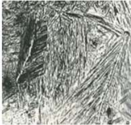
Ilustración 17-2: Microestructura de la martensita
