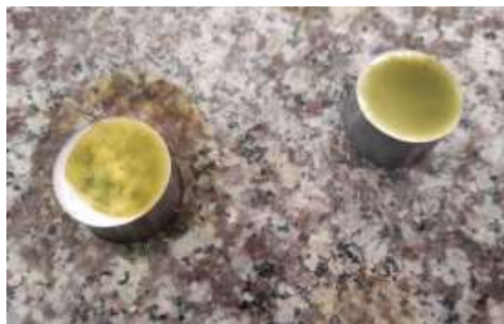
Ilustración 5-3: Probetas atacadas químicamente con VILLELA
