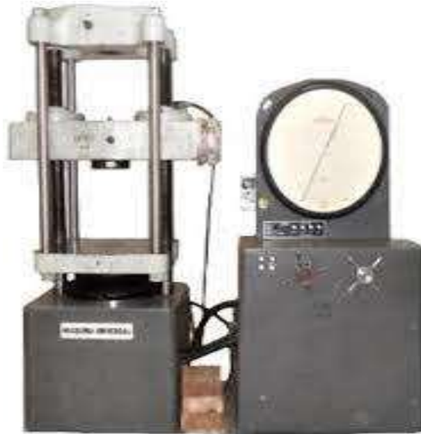
Ilustración 19-2: Maquina Universal (ensayos de tracción)
