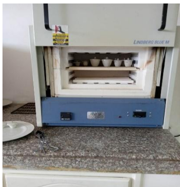
Figura 16: Incineración en la mufla
