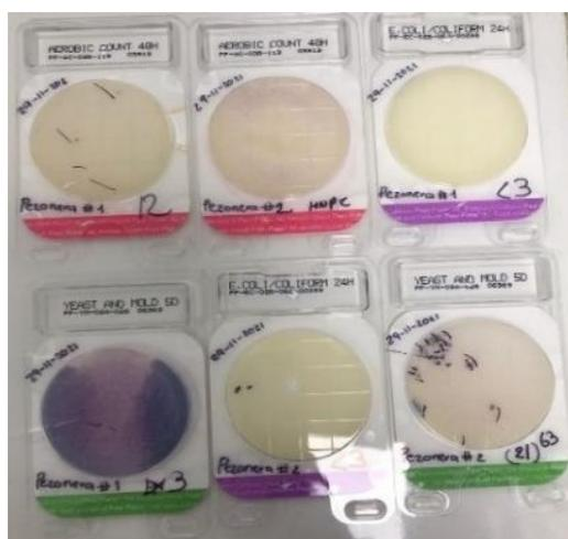
**Figura 5-3.** Análisis de la superficie de los equipos en placas Petri Film
