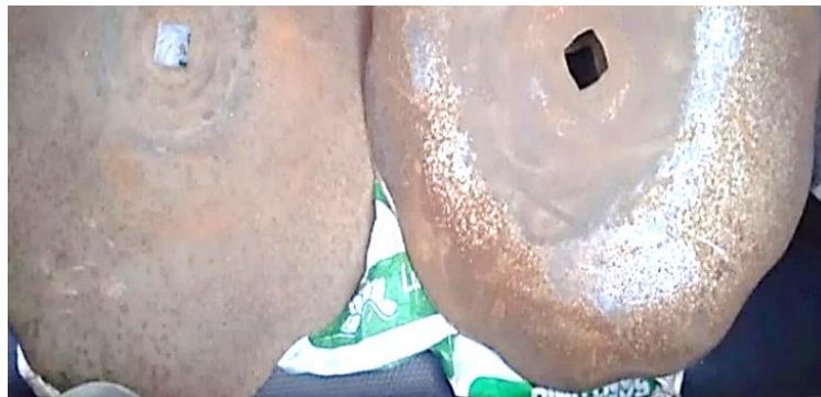
Ilustración 6-1: Discos de arado dentados desgastados.
