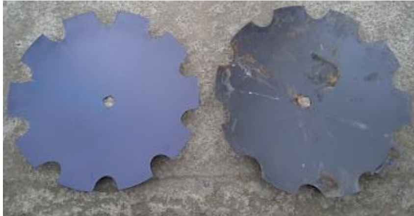
Ilustración 5-1: Discos dentados, escotados o con muescas.
