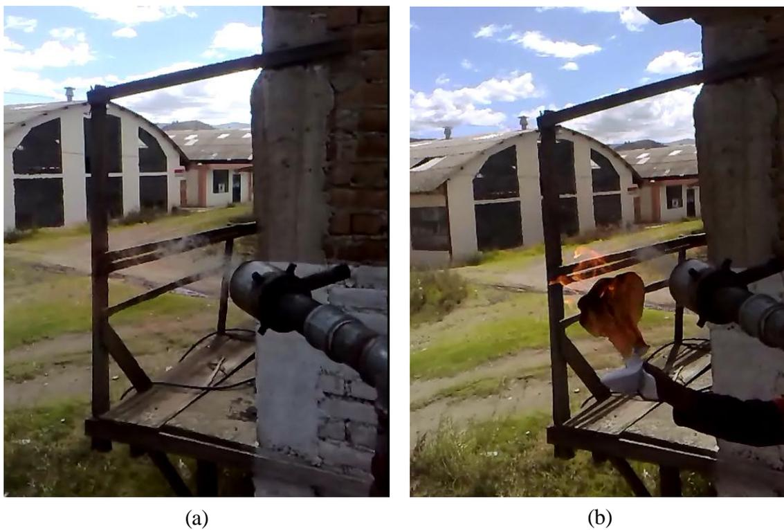
**Figura 4.20:** a) funcionamiento del gasificador con leña; b) encendido del quemador.
