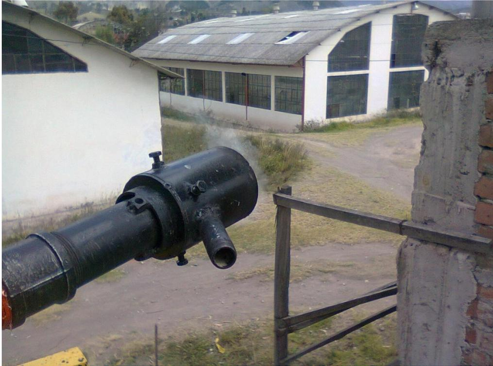
**Figura 4.24:** Colocación y encendido del quemador de gas pobre.
