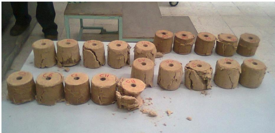
**Figura 3.46:** Briquetas luego del ensayo de resistencia al aplastamiento.
