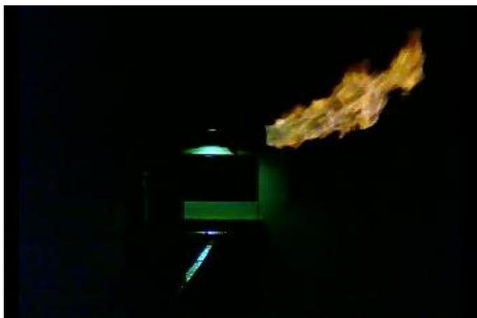
**Figura. 5.6:** Gasificación de briquetas de cascarilla de arroz.
