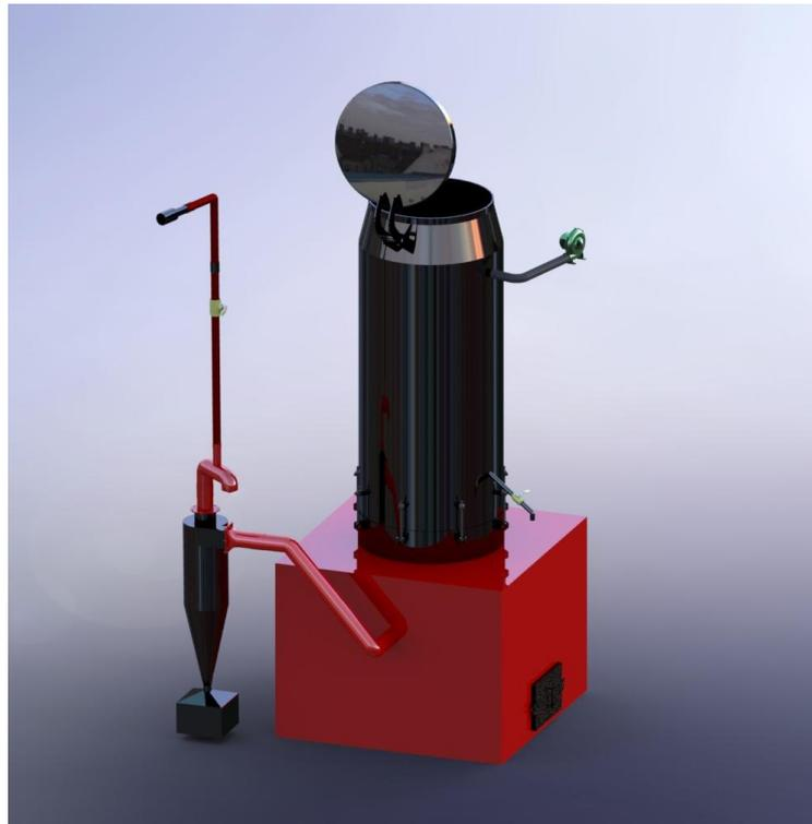
**Figura 4.26:** Gasificador en perspectiva trimétrica.
