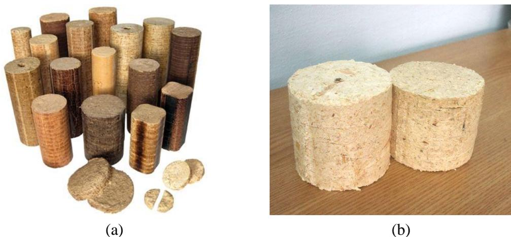
**Figura 3.1:** Tipos de briquetas: a) formas usuales [18]; b) briquetas de aserrín [19].
