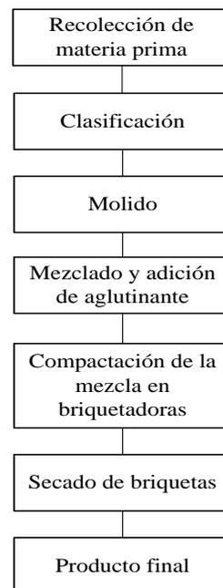
**Figura 3.22:** Proceso de briquetado.
