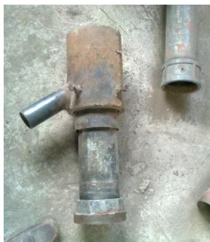
**Figura 4.9:** Adaptación de un quemador tipo jet para gas pobre.
