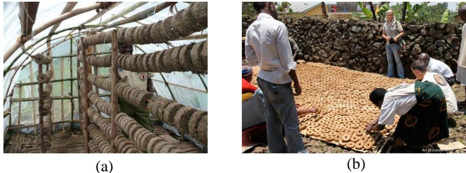
**Figura 3.24:** Secado de briquetas: a) en invernadero [57]; al aire libre [58].
