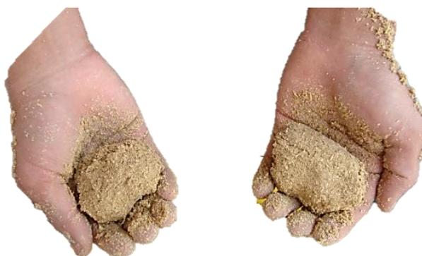
**Figura 3.38:** Comprobación del tipo de mezcla, método de arenas de moldeo.
