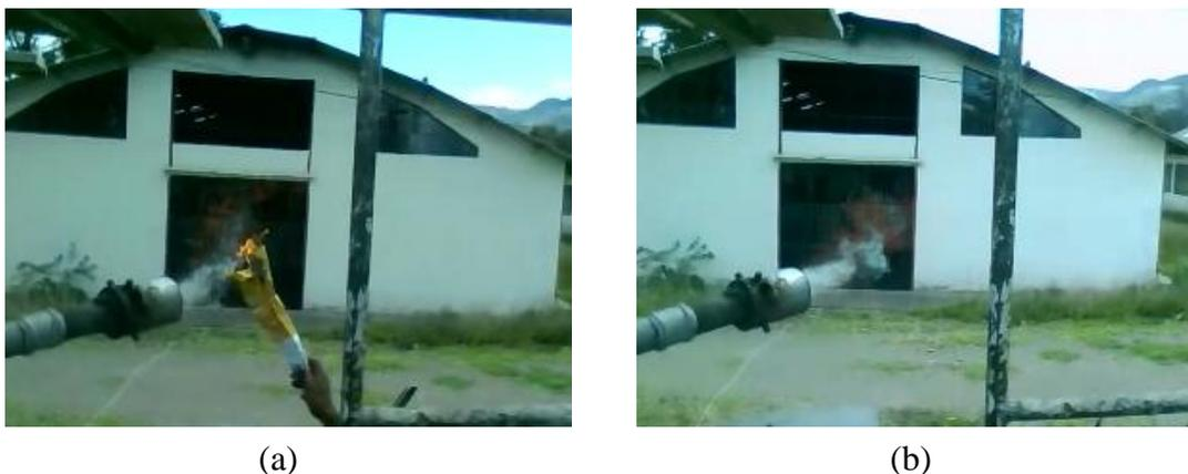
**Figura 5.2:** Gasificación de leña: a) encendido de la llama; b) verificación de producción de gas.
