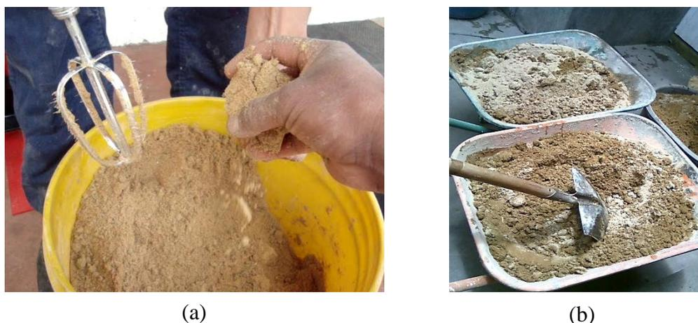
**Figura 3.36:** Proceso de mezclado: a) mezclador tipo hélice; b) mezclado manual.
