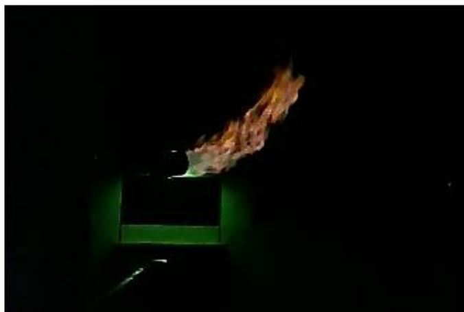
**Figura 5.4:** Gasificación de cascarilla de arroz.
