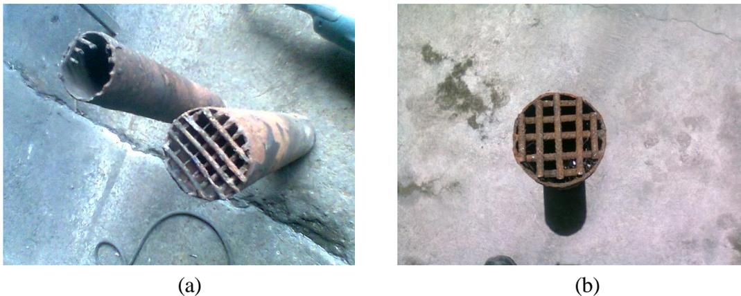
**Figura 4.8:** a) malla de los ceniceros deteriorada; b) malla de los ceniceros reparada.
