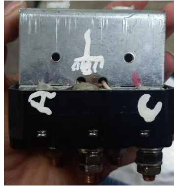
Figura 5-3: Relé 12 V cc 5 pines quemado. Realizado por: Acán, J.; Paucar, B. 2022
