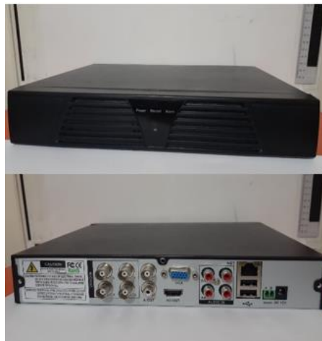
Figura 20-3: DVR, vista frontal y posterior
