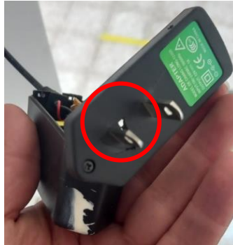
Figura 21-3: Cargador fisurado Realizado por: Acán, J.; Paucar, B. 2022
