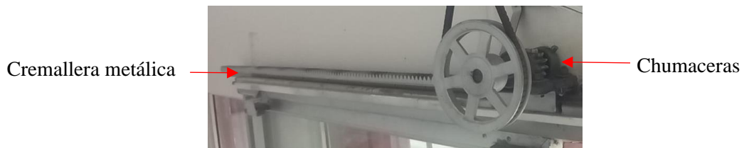
Figura 2-3: Reductor de velocidad (Parte 2) Realizado por: Acán, J.; Paucar, B. 2022
