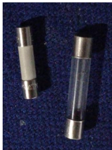
Figura 12-3: Fusibles 2A y 15A quemados Realizado por: Acán, J.; Paucar, B. 2022
