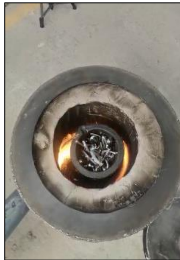
Figura 33-4: Colocación del aluminio.
