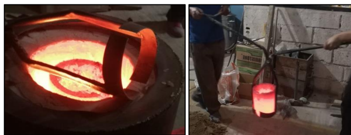
Figura 36-4: Retiro del crisol.
