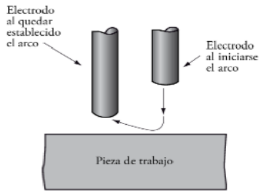
Figura 5-2: Encendido del arco, método vertical
