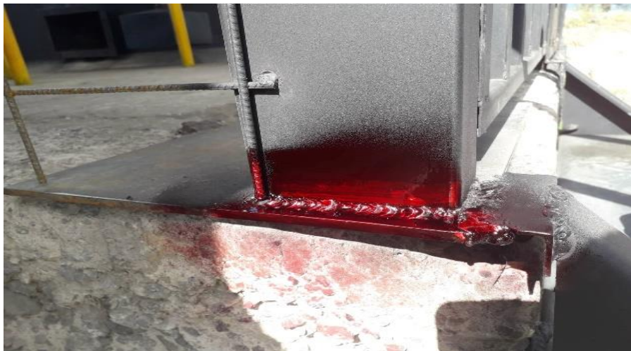
Figura 56-4: Tiempo de permanencia del penetrante
