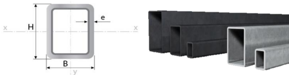
Figura 11-3: Tubería estructural rectangular
