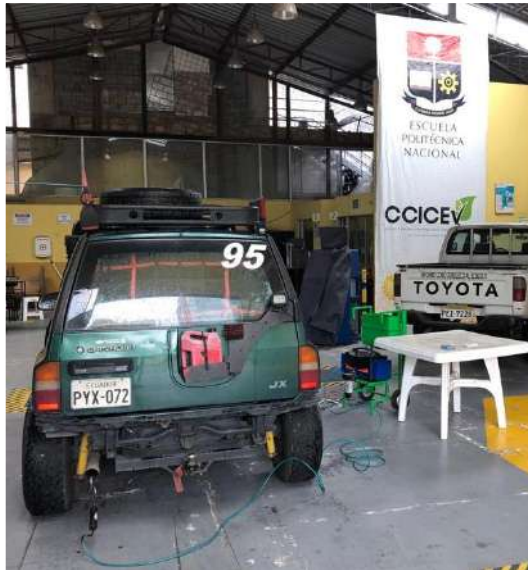
Ilustración 6-3: Prueba de emisiones de gases
