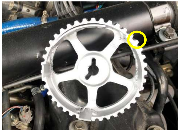
Ilustración 14-4: Dientes fabricados en la polea del árbol de levas
