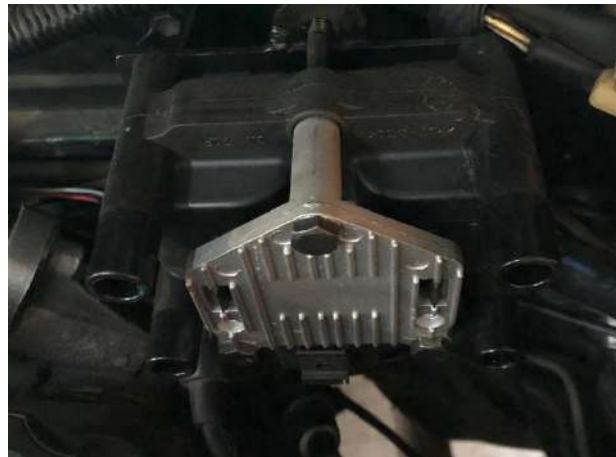
Ilustración 21-4: Bobina doble de chispa perdida
