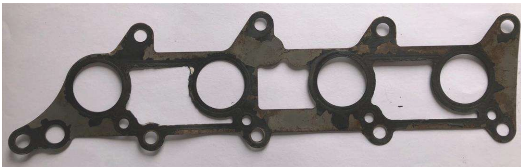
Ilustración 4-4: Empaque del múltiple de admisión del vehículo de prueba
