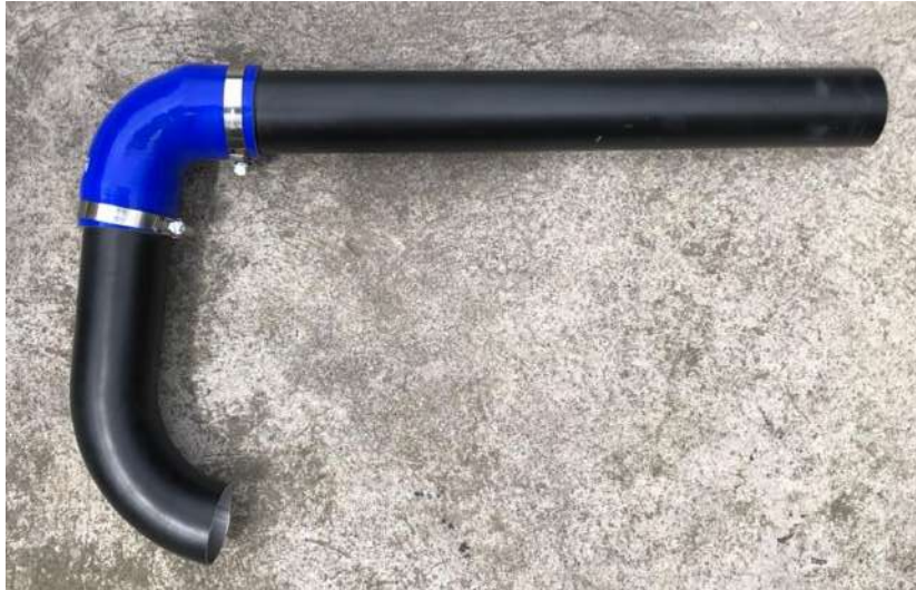
Ilustración 10-4: Mangueras ocupadas para la conexión del depurador del vehículo
