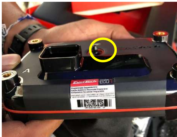
Ilustración 18-4: Conexión del sensor MAP
