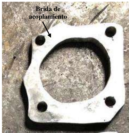
Ilustración 7-4: Brida de acoplamiento para el cuerpo de aceleración
