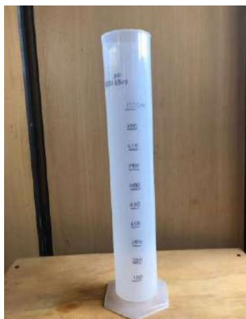
Ilustración 10-3: Probeta utilizada para medir el combustible restante
