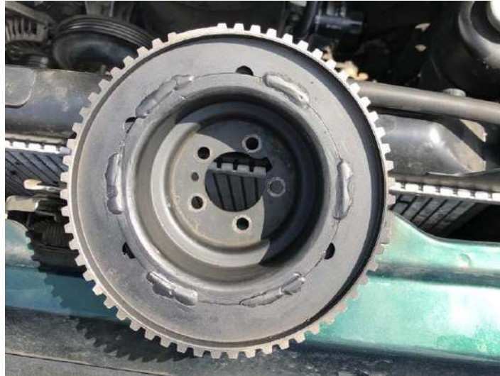
Ilustración 12-4: Rueda fónica adaptada a la polea de accesorios del motor
