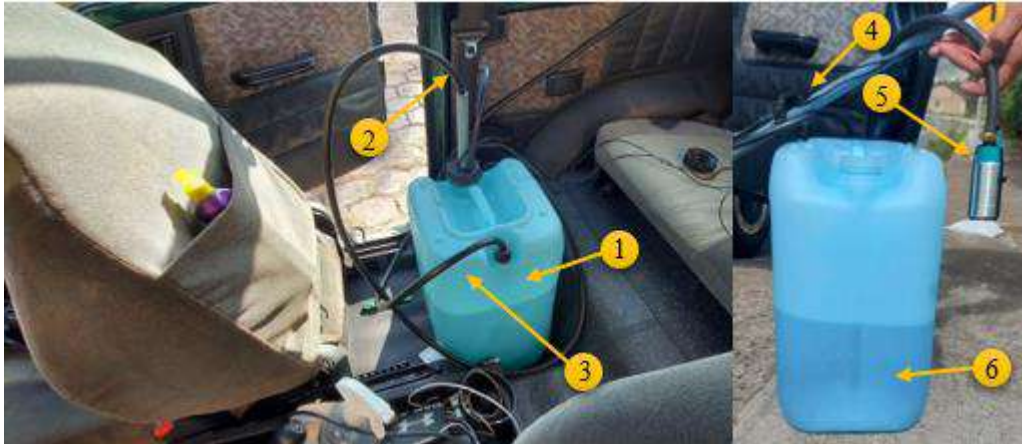
Ilustración 9-3: Tanque externo para evaluar el consumo de combustible
