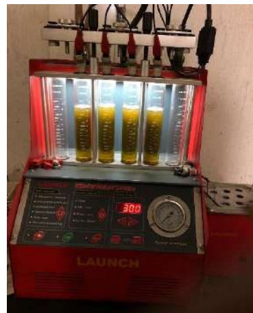
Ilustración 20-4: Prueba de flujo de los inyectores
