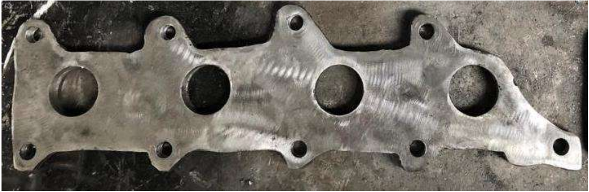
Ilustración 8-4: Brida de acoplamiento hacia el cabezote del vehículo
