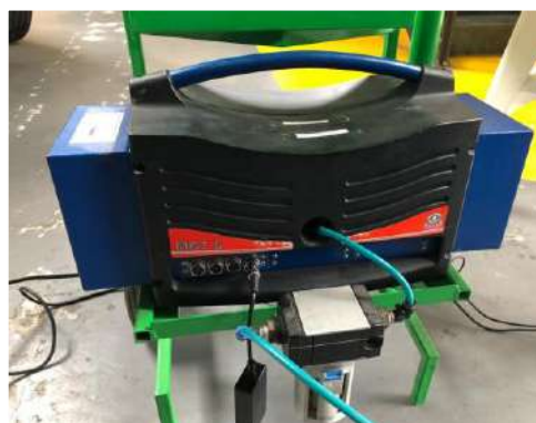
Ilustración 8-3: Analizador de gases MAHA MGT 5
