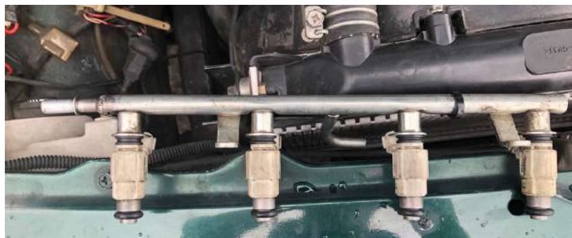
Ilustración 11-4: Riel de inyectores seleccionado para la modificación
