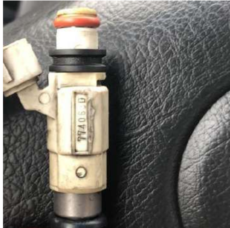
Ilustración 19-4: Inyector de alta impedancia
