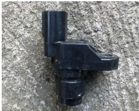
Ilustración 16-4: Sensor CMP de efecto hall
