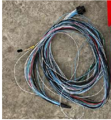
Ilustración 22-4: Ramal de cables de conexión
