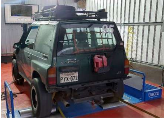
Ilustración 15-3: Vehículo de estudio en el banco de pruebas Bapro
