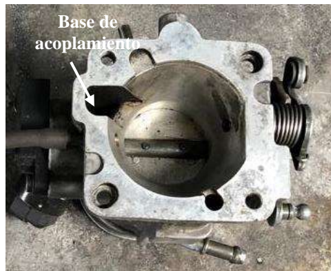
Ilustración 3-4: Base de acoplamiento hacia el múltiple de admisión
