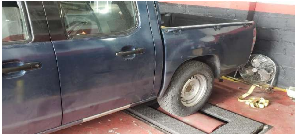
Ilustración 3-3: Prueba experimental de conducción en dinamómetro
