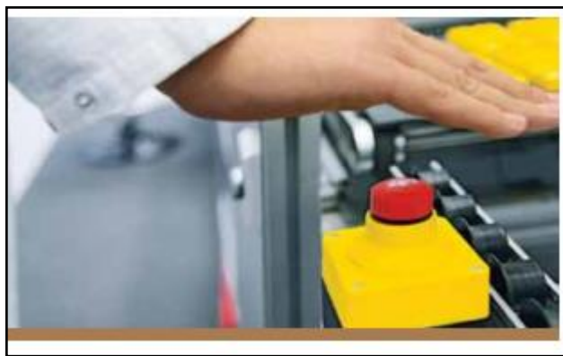
Figura 14-2: Paro de emergencia.
