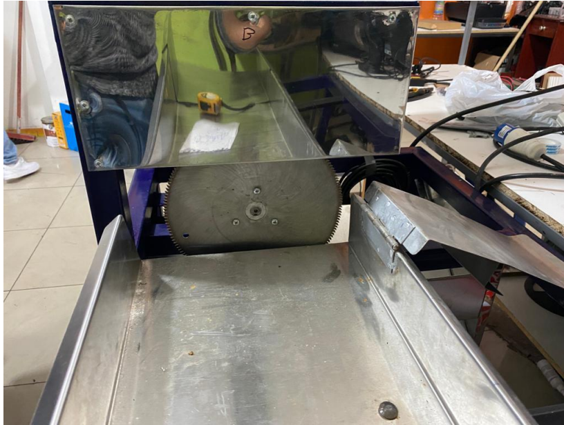
Ilustración 18-3: Instalación de la sierra de corte.
