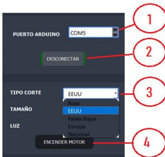
Ilustración 22-3: Control y configuración del modo de funcionamiento de la máquina.
