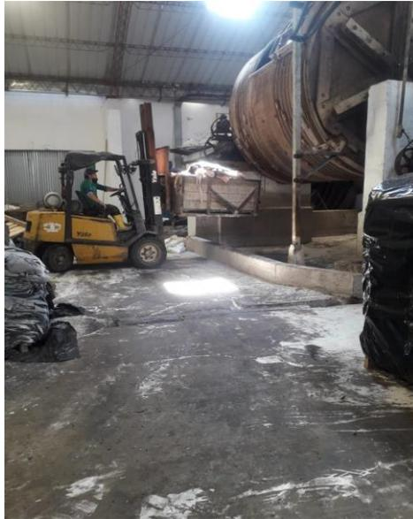
**Figura 4-3:**Bombos de pelambrado
