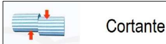
Ilustración 13-2: Esfuerzos cortantes Fuente: Torres, M. 2017
