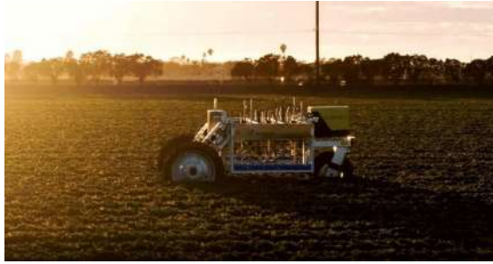
Ilustración 4-2: Agrobot cosechadora robótica de fresas Fuente: Vázquez, M.; Bravo, J. 2016
