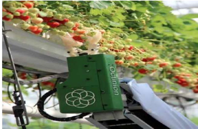
Ilustración 6-2: Octinion picking robot Fuente: Delgado, J. 2017
