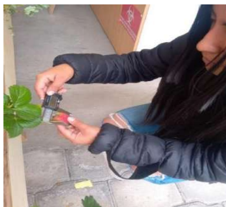
Ilustración 2-4: Longitud medida con calibrador
