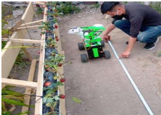
Ilustración 5-4: Pruebas de velocidad de tracción
