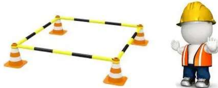
Ilustración 20-4: Delimitar la zona de trabajo
