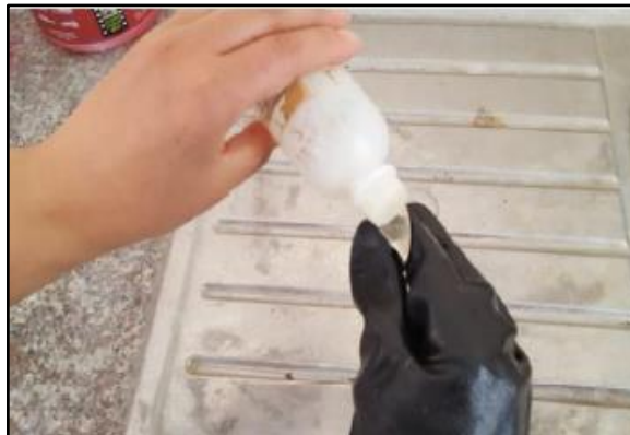
Ilustración 9-3: Ataque químico con Nital al 2%
