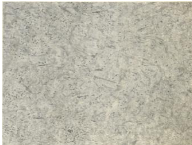
Ilustración 8-4: Microestructura con predominancia de martensita.
