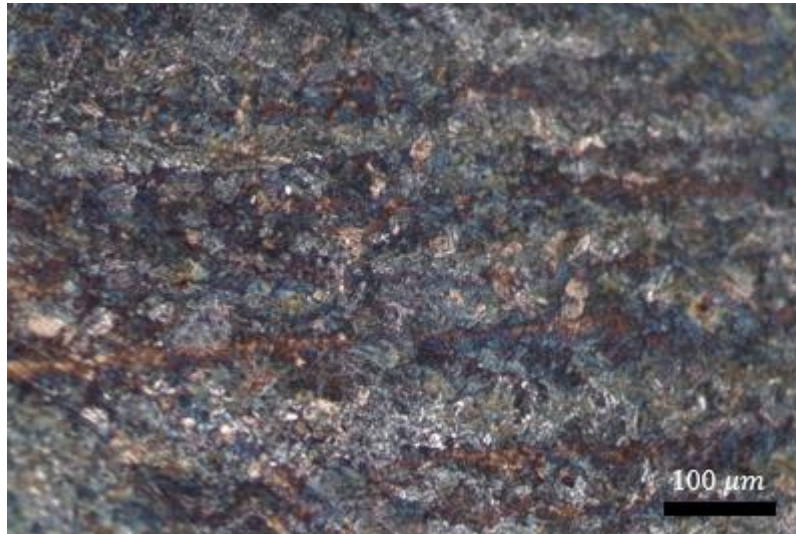
Ilustración 3-4: Microestructura del acero AISI 4340, lente objetivo 10x.
