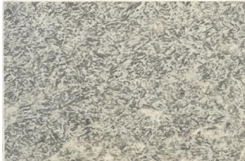
Ilustración 5-4: Microestructura del acero AISI 4340
