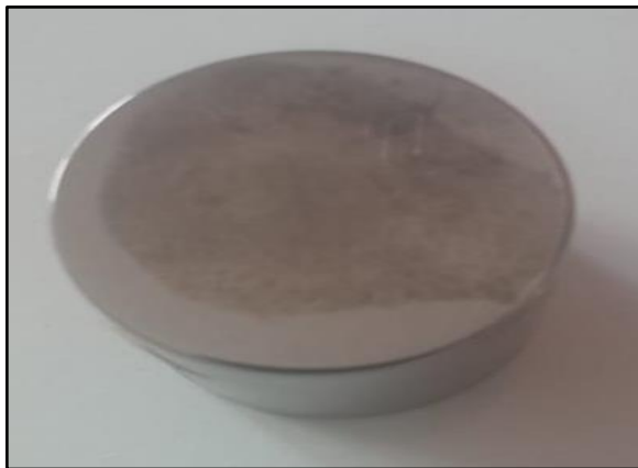
Ilustración 10-3: Probeta atacada químicamente
