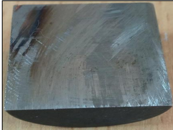
Ilustración 14-3: Probeta para inclusiones no metálicas
