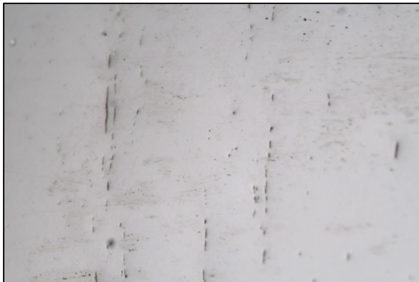
Ilustración 27-4: Fotomicrografía 2 del acero 34CrNiMo6
