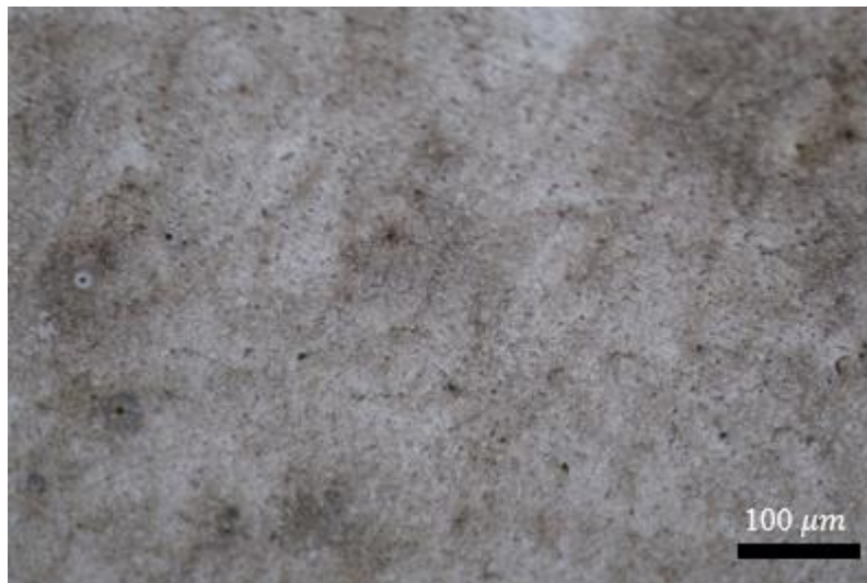
Ilustración 6-4: Microestructura del acero 34CrNiMo6, lente objetivo 10X.
