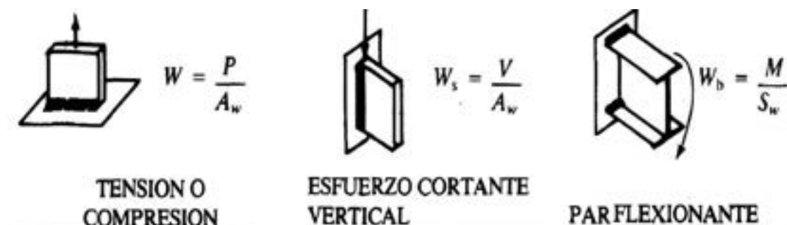
Ilustración 14-2: Tipos de carga a los que está sometido un recipiente a presión.
