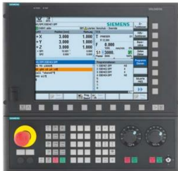
Ilustración 25: Control numérico Siemens 840d
