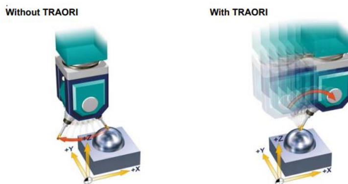
Ilustración 29: Mecanizado con 5 ejes TRAORI
