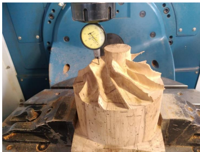
Ilustración 79: Toma de medidas con reloj comparador
