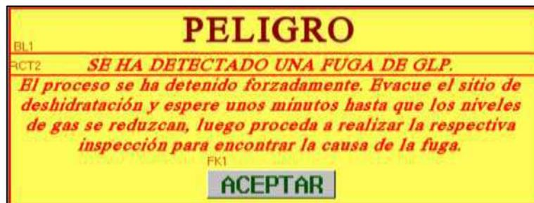
**Figura 51-3.** Ventanas emergentes HMI fuga de GLP detectada
