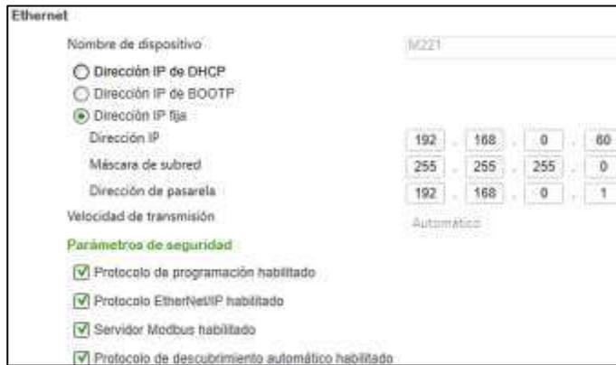
**Figura 27-3.** Configuración de puerto ethernet
