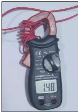
Figura 3- 5. Corriente obtenida con el proceso en pausa amplificada en un factor de 10.
