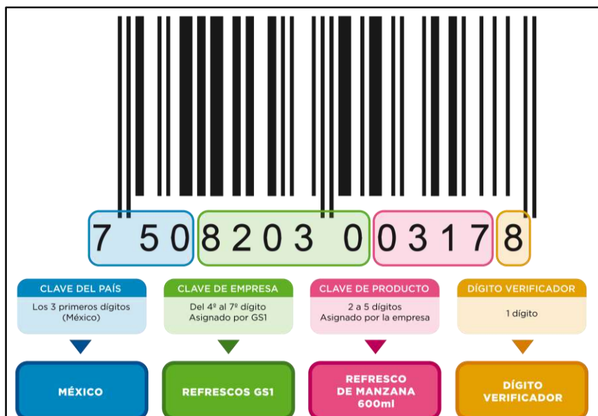
Figura 2- 2. Estructura del código de barras según el sistema EAN/UPC
