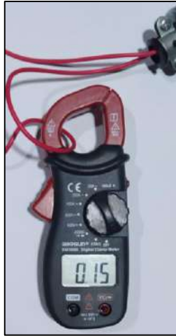
Figura 3-4. Corriente obtenida con el proceso en pausa.
