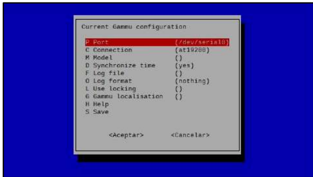
Figura 3- 18. Configuración del puerto para gammu
