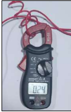
Figura 3-6. Corriente obtenida con el proceso en funcionamiento.
