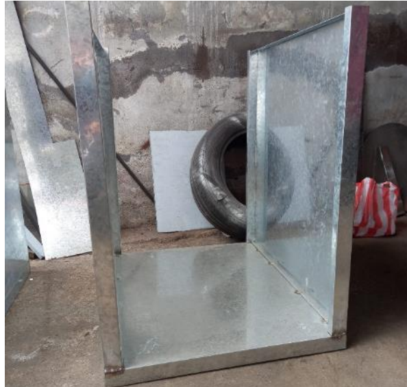
Ilustración 22-3: Base con las chapas laterales soldadas.
