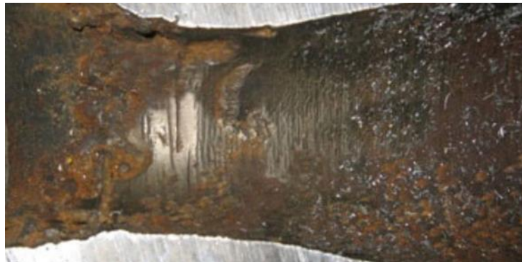
Ilustración 13-2: Corrosión bajo tensiones
