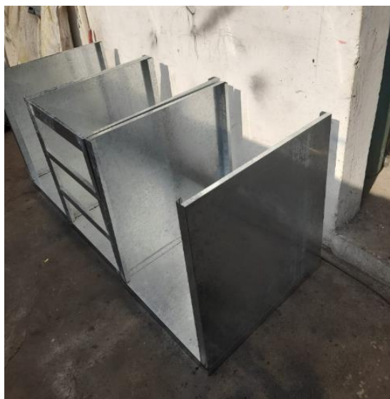
Ilustración 23-3: Submódulos con las chapas laterales
