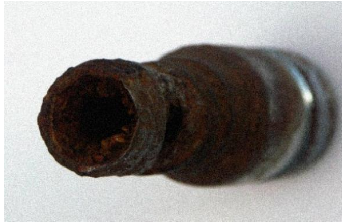
Ilustración 10-2: Corrosion por erosión.
