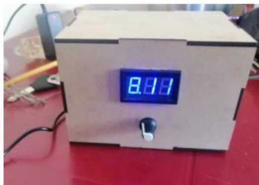
Ilustración 19-2: Regulador de voltaje
