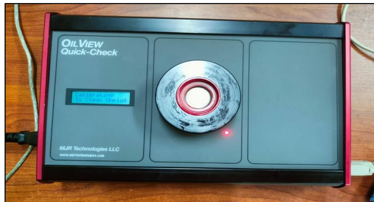
Ilustración 12-3: Equipo Oil View Quick-Check compatible con IBM PC a través de la interfaz RS-232C. Realizado por: Quinteros William & Ramos Kevin. 2022.
