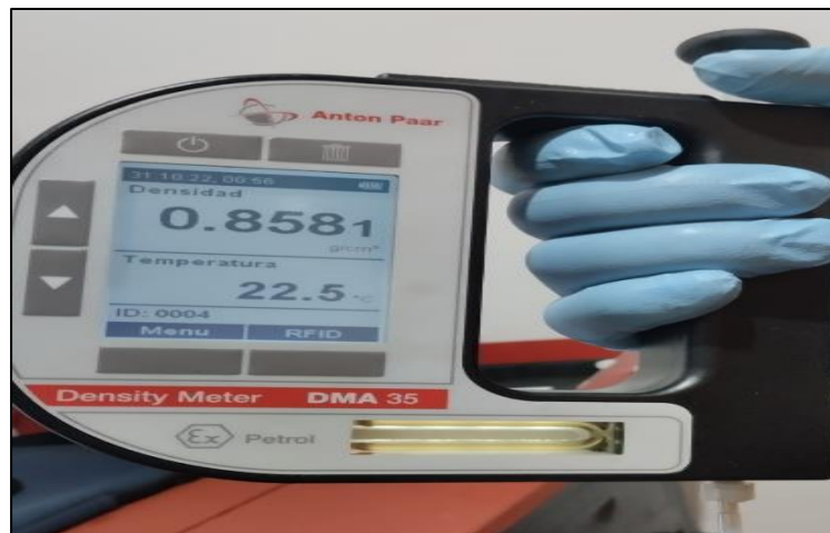
Ilustración 11-3: Medidor de densidad portátil DMA 35 basic. Realizado por: Quinteros William & Ramos Kevin. 2022
