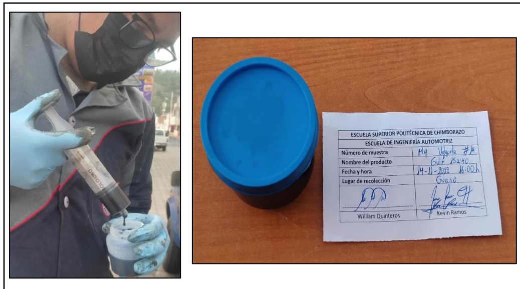
Ilustración 10-3: Envasado y etiquetado de la muestra según la norma INEN 2027. Realizado por: Quinteros William & Ramos Kevin. 2022.
