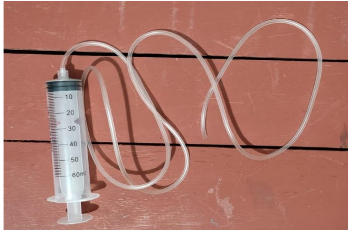
Ilustración 7-3: Dispositivo jeringuilla manguera usado para extraer aceite del motor.
