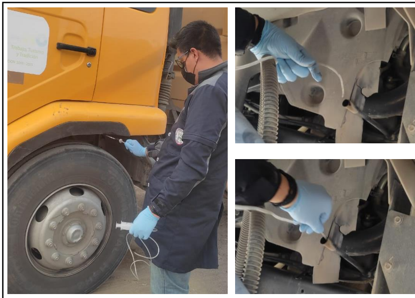
Ilustración 8-3: Procedimiento poco invasivo para la extracción de aceite lubricante del motor.
