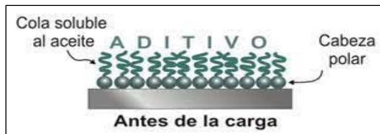
Ilustración 9-2: Actuación de las moléculas de aditivos anti-desgaste.
