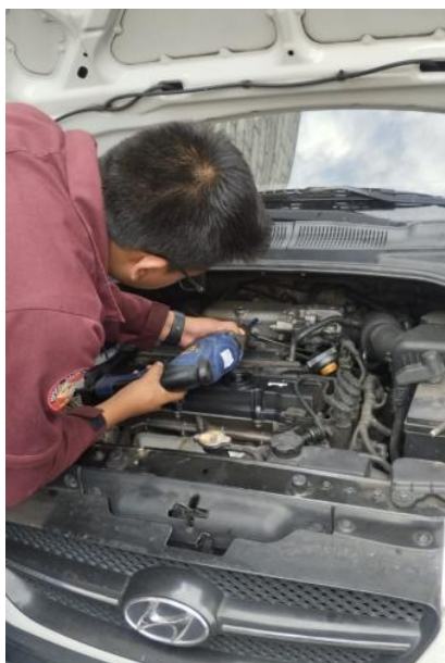
Ilustración 15-3: Perforación del múltiple de admisión
