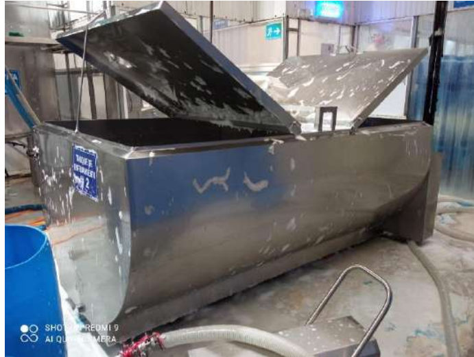
Ilustración 31-3: Limpieza de tanque de enfriamiento
