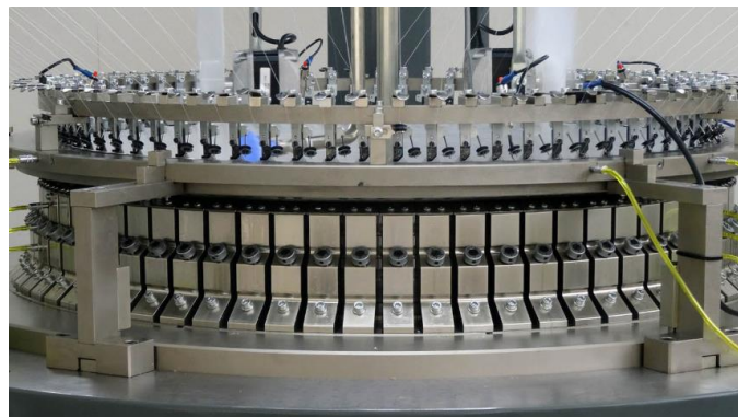
Ilustración 19-2: Fontura de agujas para máquinas circulares
