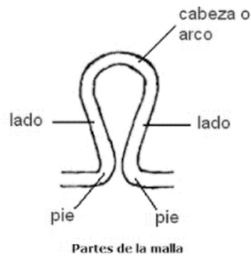
Ilustración 8-2: Partes de una malla de tejido de punto
