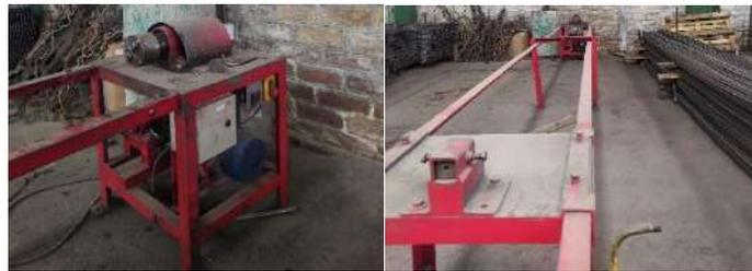
**Ilustración 15-3:** Entorchadora de varillas
