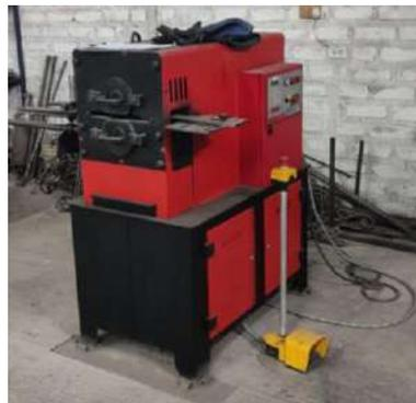
**Ilustración 13-3:** Forja en caliente NF70
