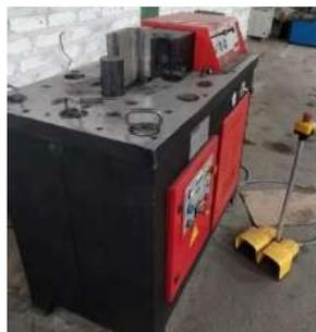
**Ilustración 3-3:** Dobladora de platinas
