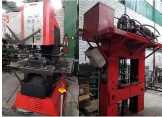
**Ilustración 7-3:** Punzonadora hidráulica
