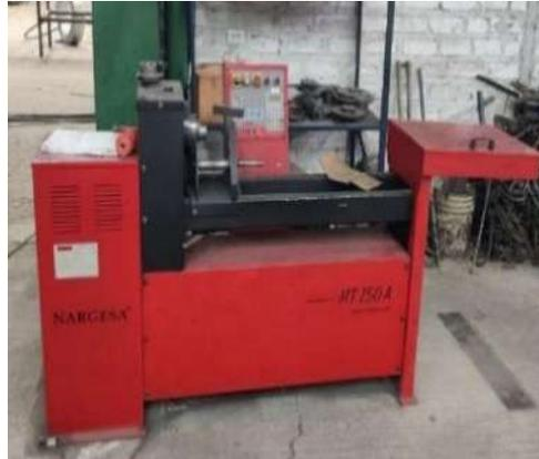
**Ilustración 5-3:** Torsionadora MT 150 A
