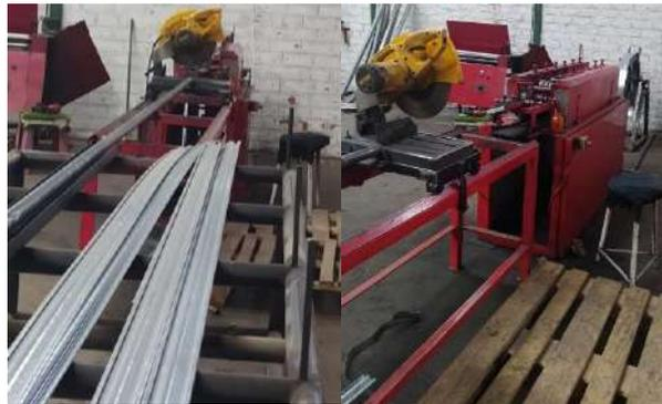
**Ilustración 9-3:** Perfiladora de flejes
