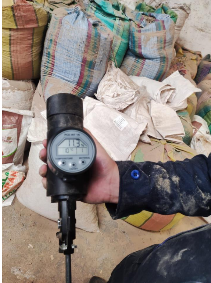
Ilustración 8-3: Medición de humedad
