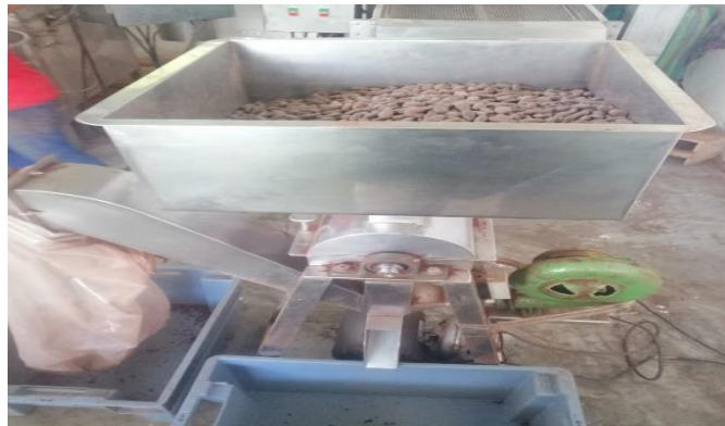
Ilustración 12-3: Proceso de trituración de los granos de cacao restantes. Realizado por: Yambay Jefferson, 2023.
