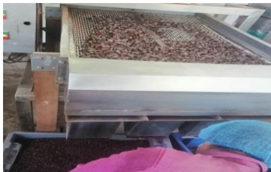
Ilustración 11-3: Proceso de descascarillado de granos de cacao.
