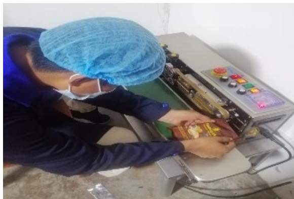
Ilustración 20-3: Proceso de sellado de las fundas de chocolate amargo.
