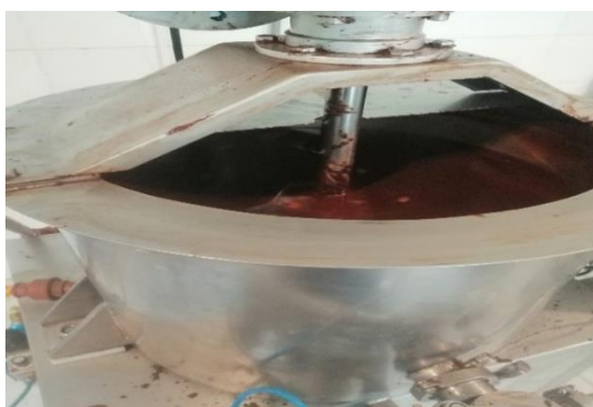
Ilustración 16-3: Proceso de atemperado de la pasta de cacao.
