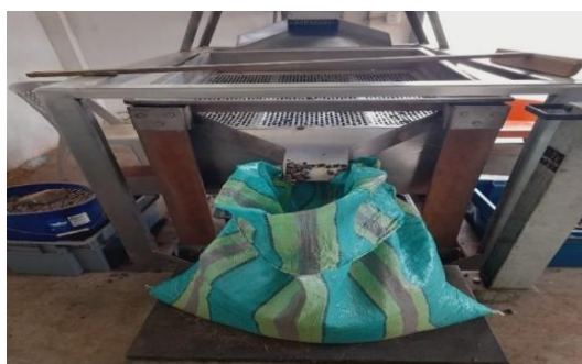
Ilustración 9-3: Proceso de clasificación de granos de cacao. Realizado por: Yambay Jefferson, 2023.
