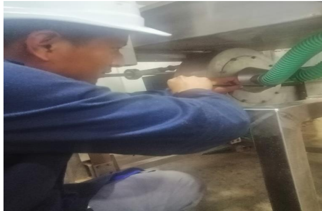
ANEXO E: MANGUERAS DE SUCCIÓN NUEVAS DE LA MÁQUINA DESCASCARILLADORA
