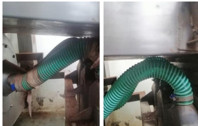
Ilustración 21-4: Cambio de mangueras de succión.
