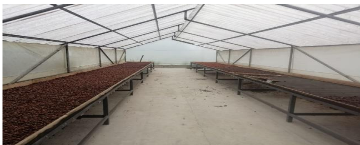
Ilustración 8-3: Proceso de secado de los granos de cacao en las marquesinas. Realizado por: Yambay Jefferson, 2023.
