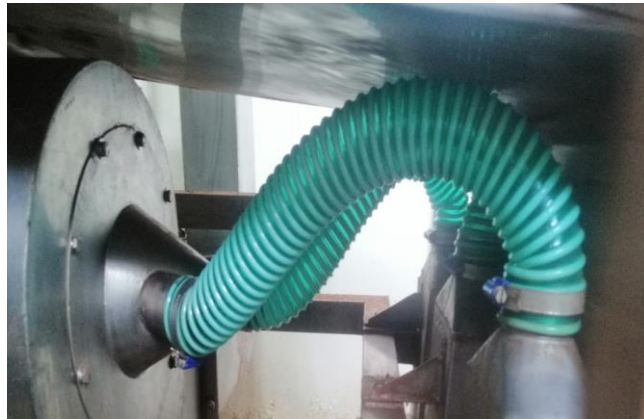
ANEXO E: MANGUERAS DE SUCCIÓN NUEVAS DE LA MÁQUINA DESCASCARILLADORA
