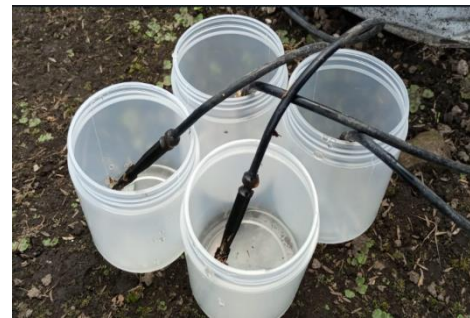
Foto 4: Aforo de goteros.
