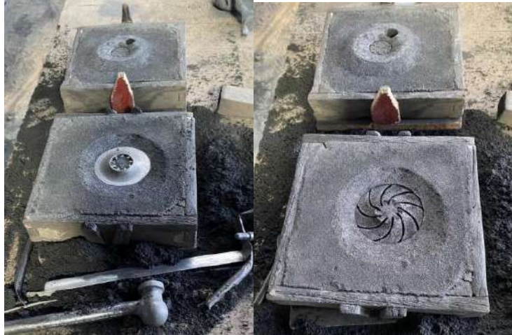
Ilustración 18-4: Moldes listas para ingreso de colada
