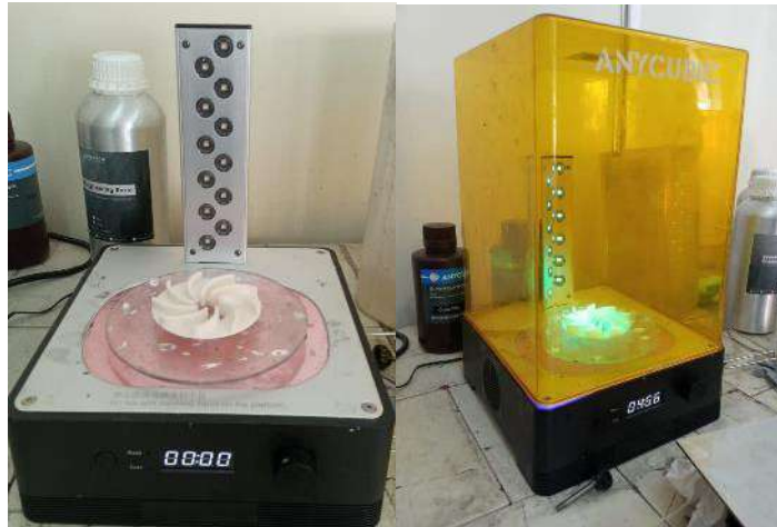
Ilustración 13-4: Proceso de secado de la pieza por luz UV
