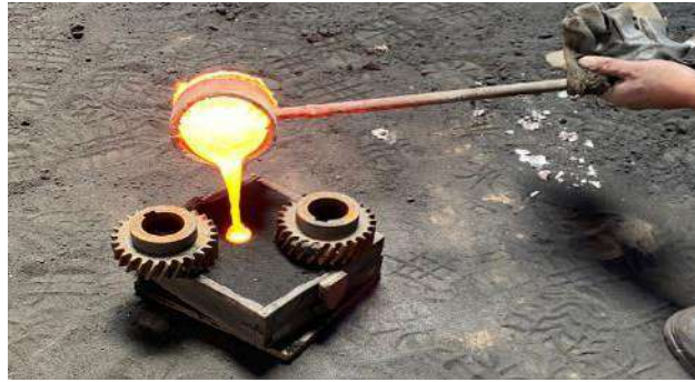
Ilustración 20-4: Colocación de la colada en los moldes.
