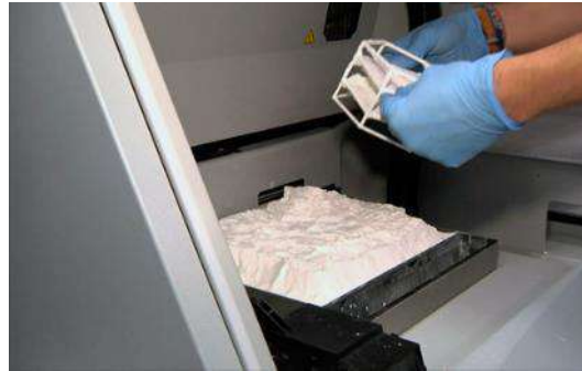
Ilustración 7-2: Impresión 3D por laser
