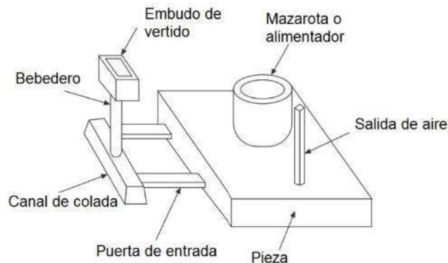
Ilustración 1-3: Sistemas de canales de fundición
