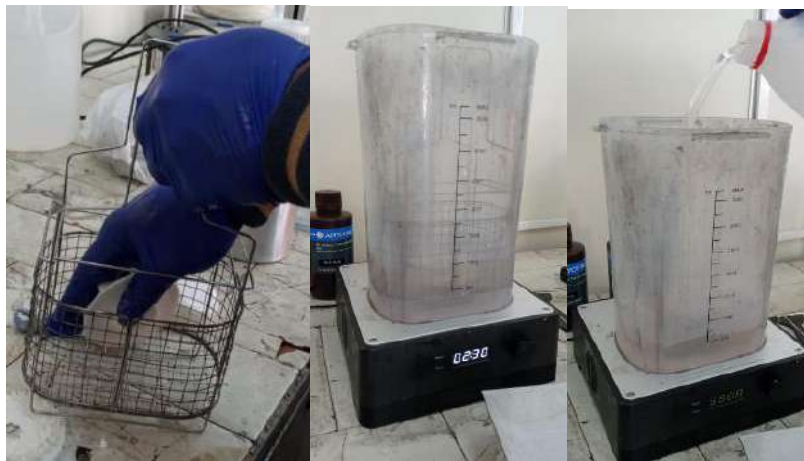
Ilustración 12-4: Proceso de lavado de la pieza impresa en resina.
