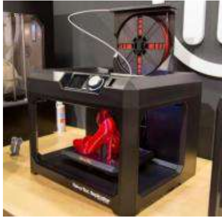
Ilustración 9-2: Impresora por deposición de material fundido Fuente: (2019)
