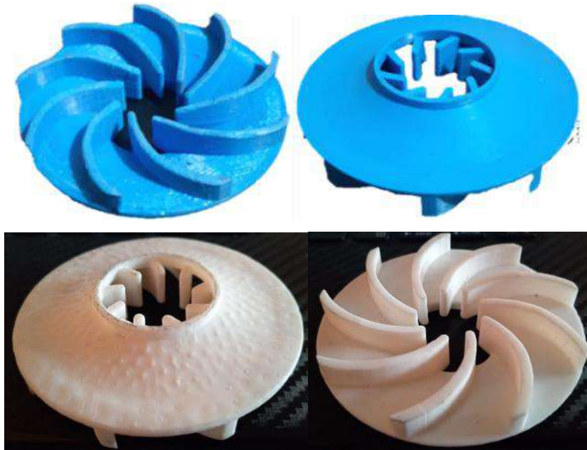
Ilustración 34-4: Impeller semiabierto impreso en Filamento PLA y Resina Realizado por: Toaquiza C, 2022
