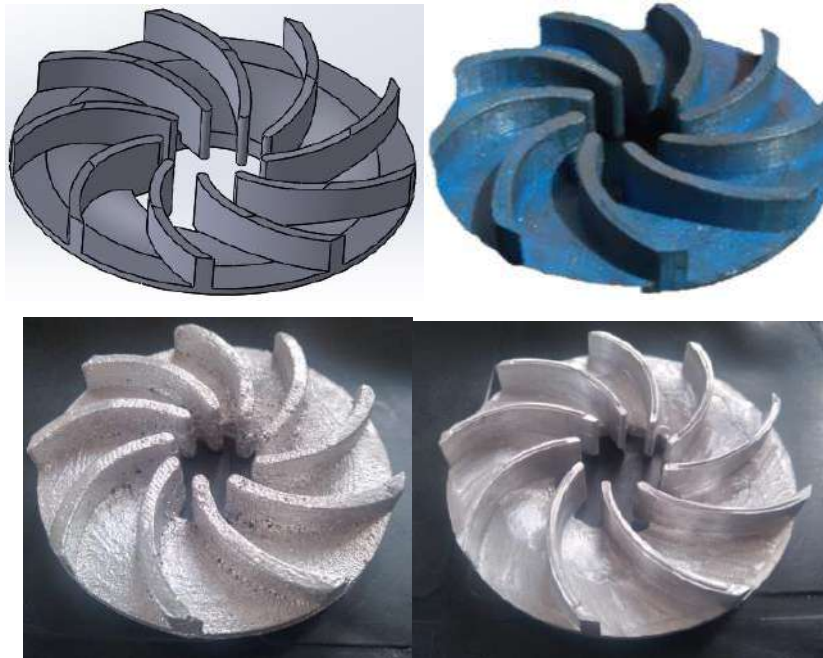
Ilustración 36-4: Impeller semiabierto Scanner, Impresión 3D, Fundición y Mecanizado.
