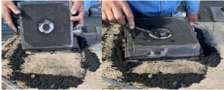
Ilustración 16-4: Compactación y retiro de exceso de arena en el molde
