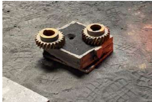
Ilustración 19-4: Colocación de las pesas en los moldes.
