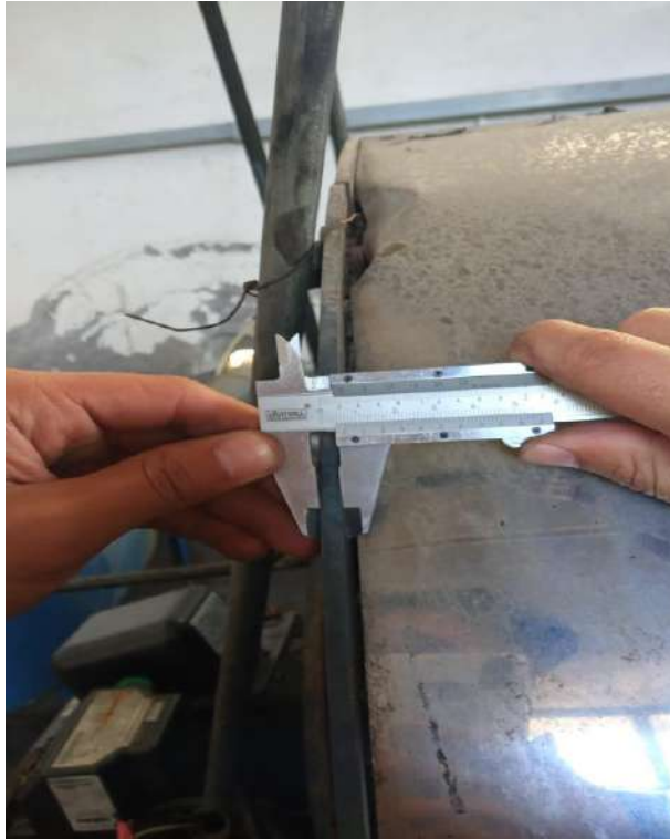
Ilustración 3-30: Medida de espesores de las planchas
