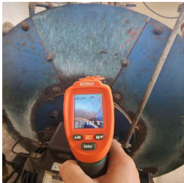
Ilustración 3-23: Imagen cara frontal con el pirómetro
