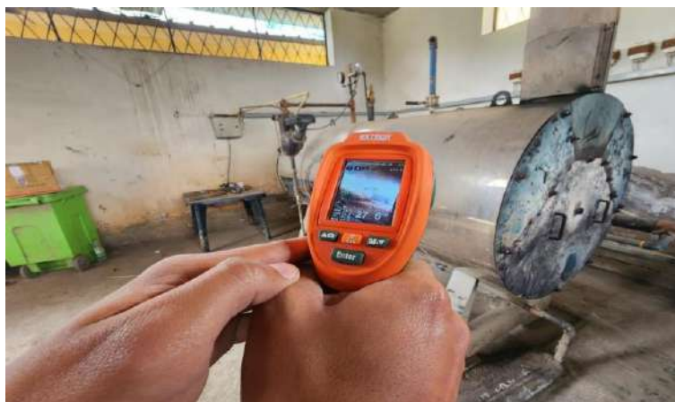
Ilustración 3-24: Imagen pared lateral con el pirómetro
