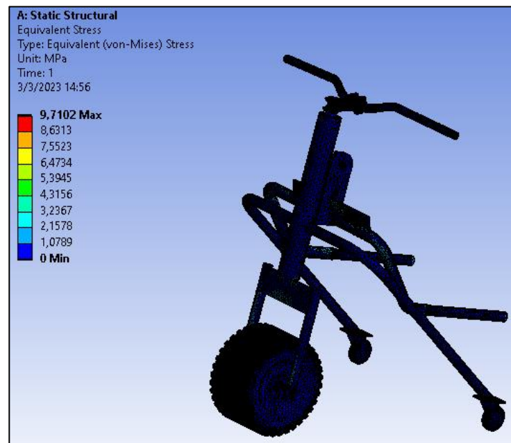
Ilustración 31-3: Esfuerzo equivalente en todo el equipo en posición estática.
