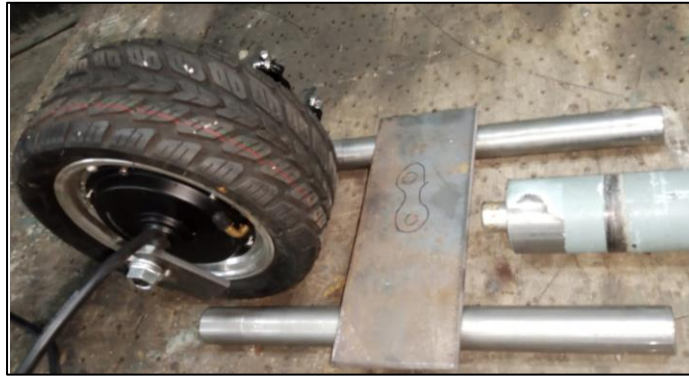
Ilustración 41-3: Armado de la horquilla
