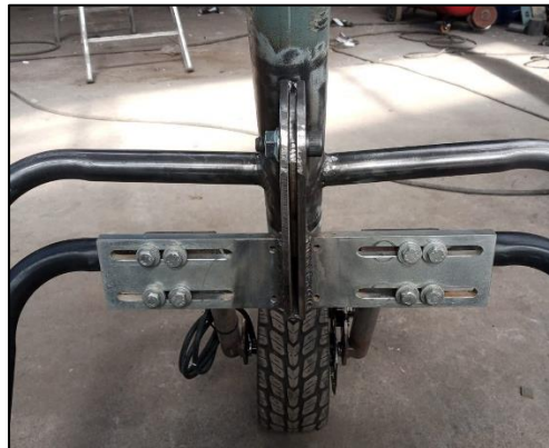
Ilustración 46-3: Placas de los brazos anclados a la horquilla
