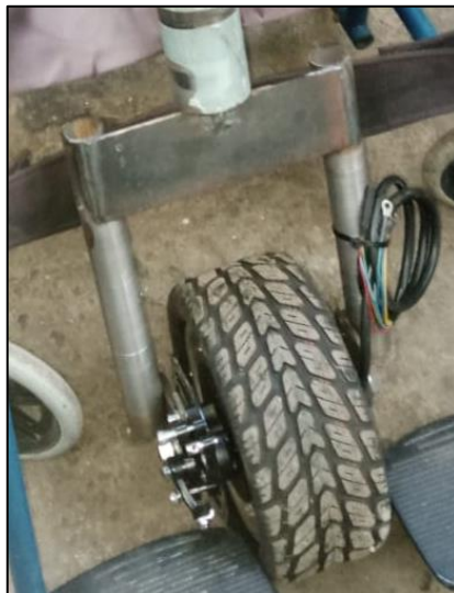
Ilustración 42-3: Horquilla unida mediante soldadura
