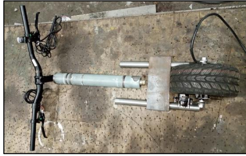
Ilustración 45-3: Instalación de los elementos del manubrio.
