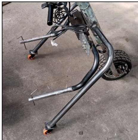
Ilustración 48-3: Apoyos soldados a la horquilla
