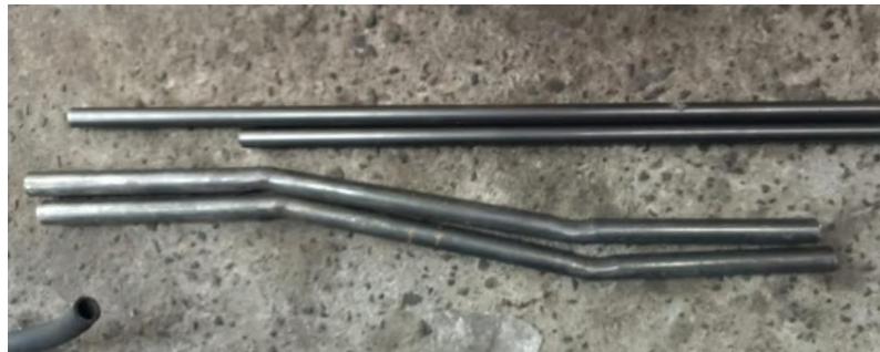
Ilustración 22-3: Tubos cortados y doblados de acuerdo con el diseño
