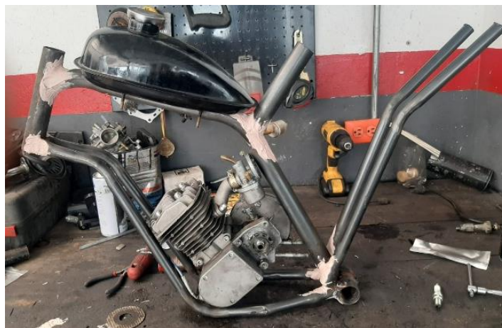
Ilustración 24-3: Montaje del motor en el marco
