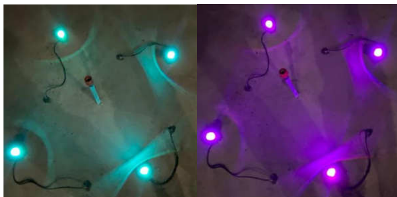
Ilustración 4-12: Prueba del sistema de iluminación anillo interno
