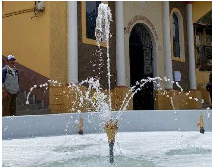
Ilustración 4-15: Prueba sistema de bombeo, tobera central Realizado por: Abarca M., Hernández L., 2023
