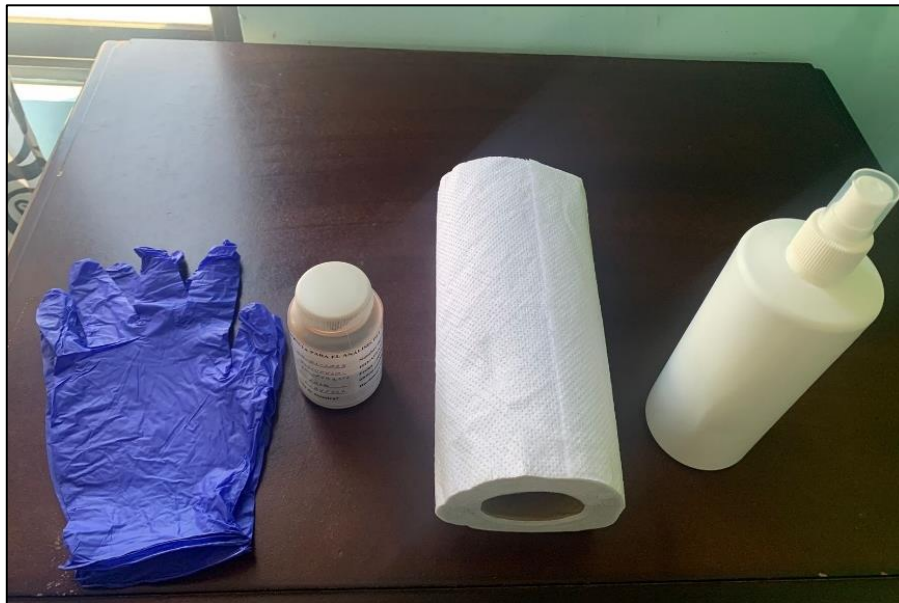
Ilustración 8-3: Materiales para la utilización del densímetro (Guantes, muestra de aceite, papel absorbente y alcohol)
