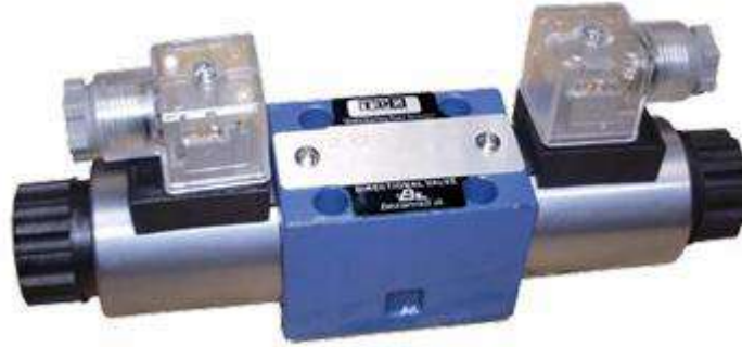
Ilustración 3-53: Electroválvula direccional 4/3 Cetop 3 centro abierto, de la marca TDZ Bezares Group
