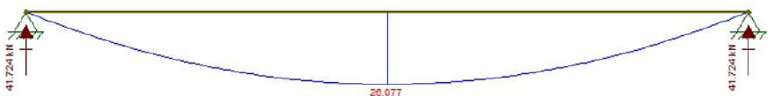
Ilustración 3-43: Diagrama de momentos para la muela, utilizando software especializado.
