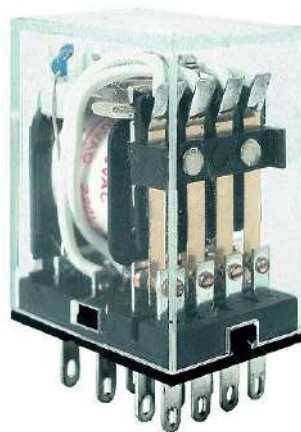
Ilustración 2-14: Relé auxiliar extraíbles con 4 polos inversores, bobina de 220 Vca.
