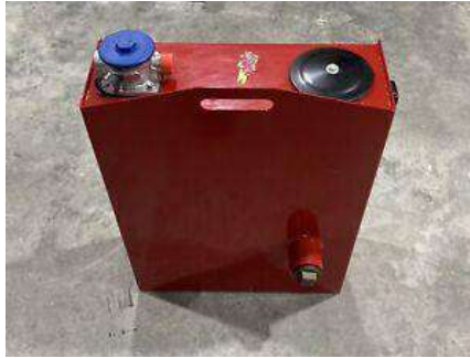
Ilustración 2-6: Depósito de líquido hidráulico, capacidad de 20 litros.
