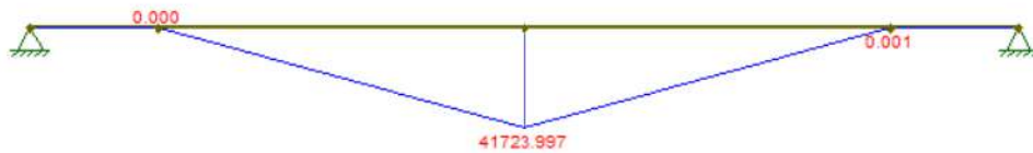
Ilustración 3-12: Diagrama de momentos flectores en el plano X-Y en la posición inicial del delantal, obtenido por software especializado
