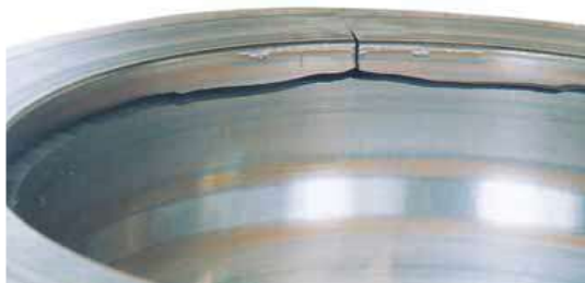
Ilustración 16-2: Rajaduras que se propagan axialmente
