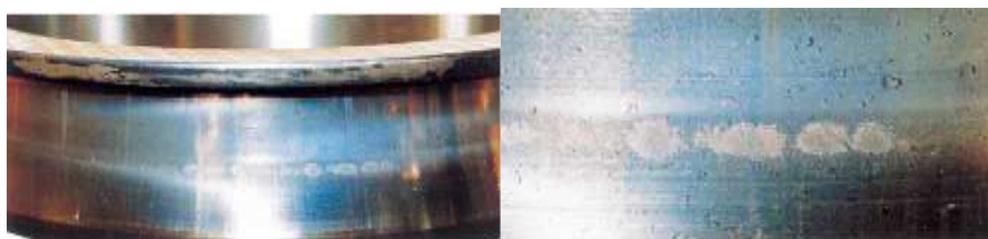
Ilustración 12-2: Desgaste a lo largo de la pista interna con su ampliación
