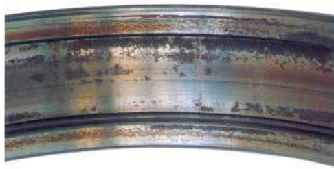
Ilustración 18-2: Oxidación en la superficie de la pista
