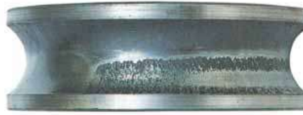
Ilustración 11-2: Descamación a lo largo de la pista
