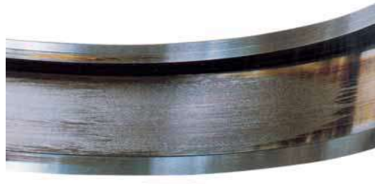
Ilustración 14-2: Adherencia por patinaje Fuente: (NSK 2017)
