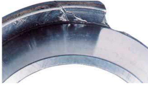
Ilustración 15-2: Fractura en la pestaña de la pista interna
