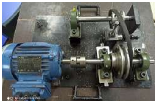
Ilustración 4-3: Instalación de la banda Realizado por: García Jefferson, 2023
