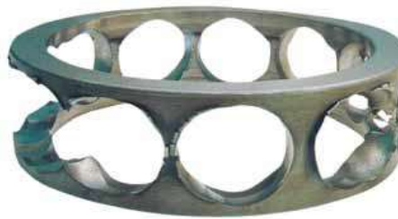
Ilustración 17-2: Jaula fracturada con desgaste del pilar
