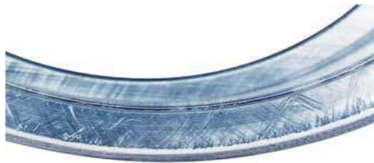
Ilustración 13-2: Rayaduras en la pista interna Fuente: (NSK 2017)
