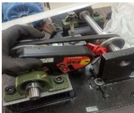
Ilustración 7-3: Alineación de poleas Realizado por: García Jefferson, 2023
