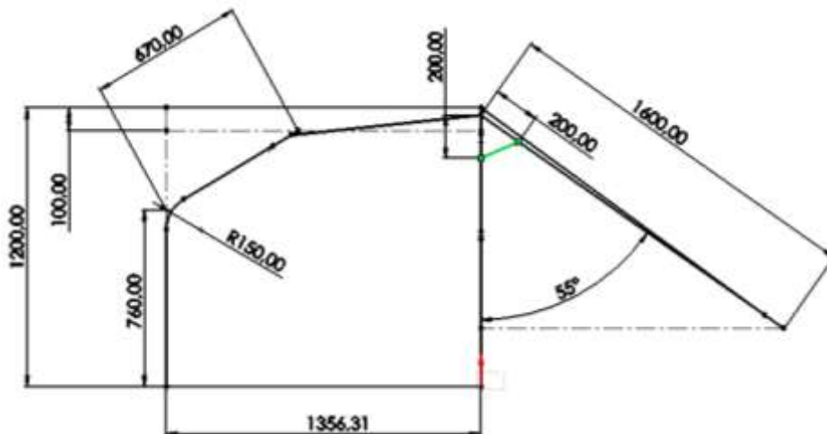
Ilustración 21-3: Cartela / Escuadra de refuerzo obligatoria (línea verde)
