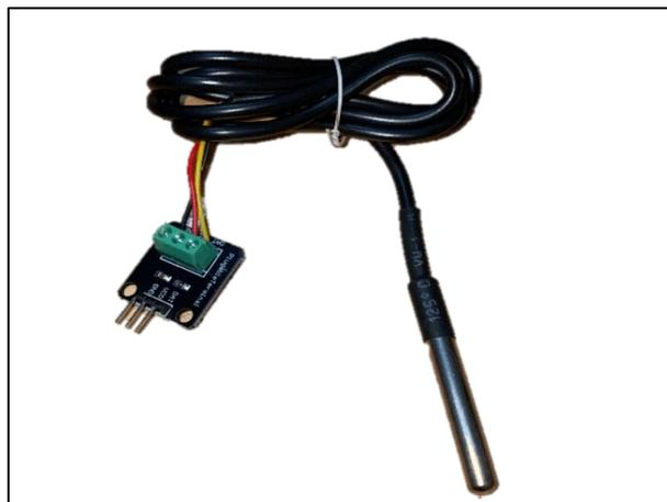
**Ilustración 4-3:** Sensor de temperatura DS18B20
