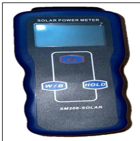
**Ilustración 2-3:** Piranómetro SM206-SOLAR
