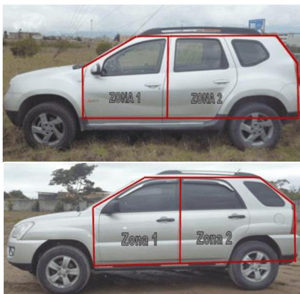
**Ilustración 17-3:** Zonas térmicas de las cabinas de los vehículos de prueba
