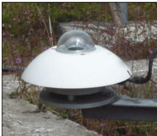
**Ilustración 3-3:** Piranómetro SR11 Hukseflux
