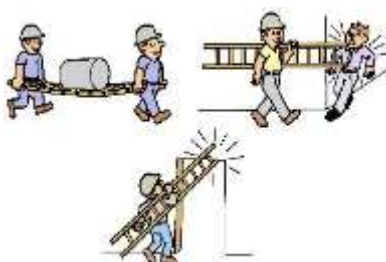
Incorrecto Transporte, punto de apoyo
