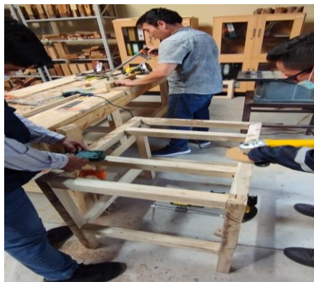
Ilustración 8-3: Proceso de lijado de la madera
