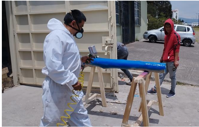
Ilustración 11-3: Puesto de Aplicación de pinturas.
