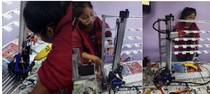
Ilustración 38-3: Construcción del mecanismo de desplazamiento X, Y. Realizado por: Guanga J., Chacaguasay M.,2023
