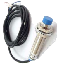
Ilustración 23-3: Sensores posición sistema robótico. Realizado por: Guanga J., Chacaguasay M.,2023
