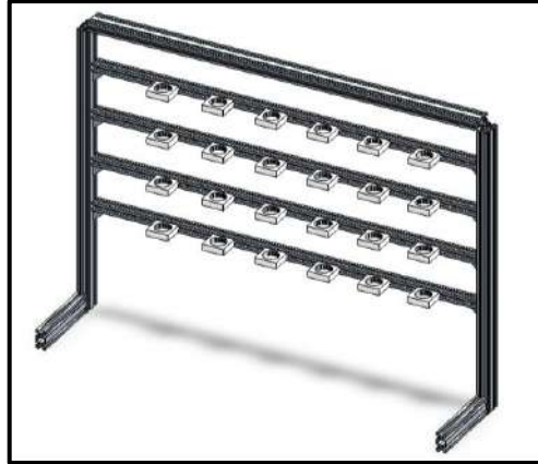
Ilustración 5-3: Rack de almacenamiento vertical. Realizado por: Guanga J., Chacaguasay M.,2023
