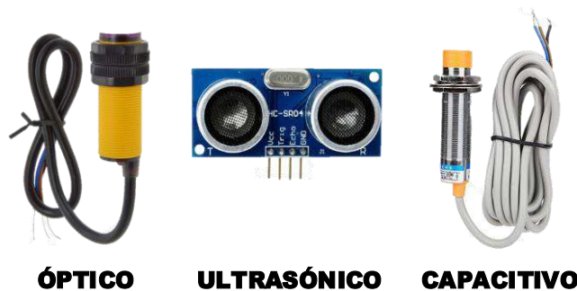
Ilustración 22-3: Sensores posición banda transportadora. Realizado por: Guanga J., Chacaguasay M., 2023
