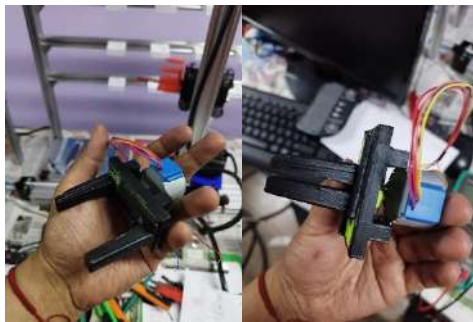
Ilustración 40-3: Construcción del gripper. Realizado por: Guanga J., Chacaguasay M.,2023
