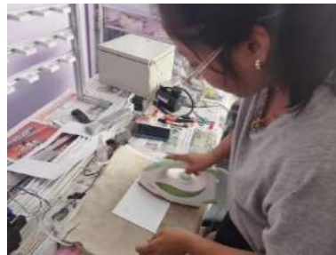
Ilustración 42-3: Transferencia de la placa electrónica. Realizado por: Guanga J., Chacaguasay M.,2023
