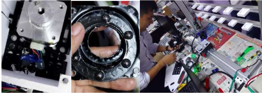
Ilustración 39-3: Construcción del mecanismo de giro. Realizado por: Guanga J., Chacaguasay M.,2023
