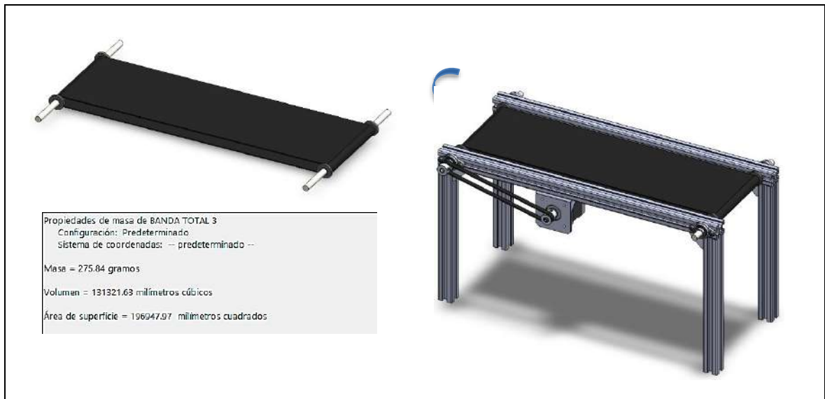
Ilustración 18-3: Análisis de las propiedades físicas de la banda transportadora
