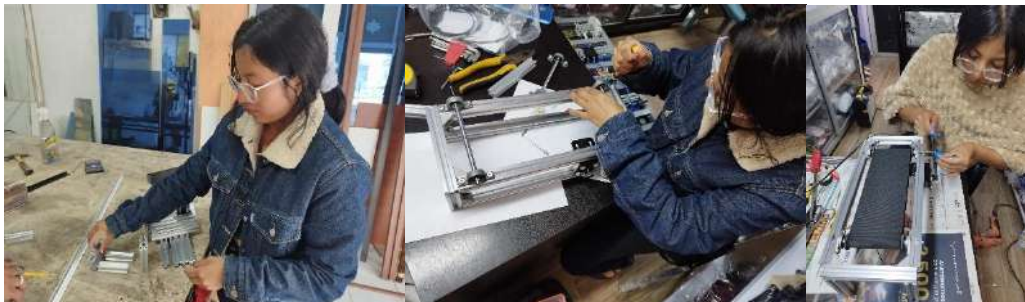
Ilustración 36-3: Construcción de las bandas transportadoras. Realizado por: Guanga J., Chacaguasay M.,2023
