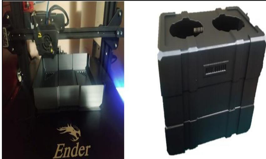
Ilustración 38-3: Impresión 3D del case. Realizador por: Bejarano, J; Sarango, C. 2023
