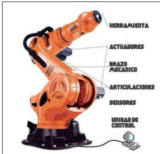
Figura 3-2: Elementos Básicos de un Brazo Robótico
