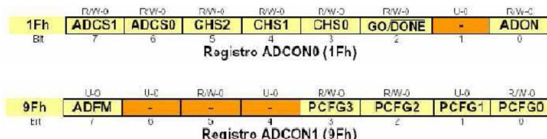
Figura VI. 35. Registros de Control del convertidor A/D del PIC 16F877A.
