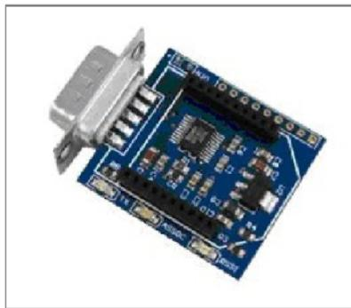
Figura II. 8 Interfaz Droids SAS XBee – DTE
