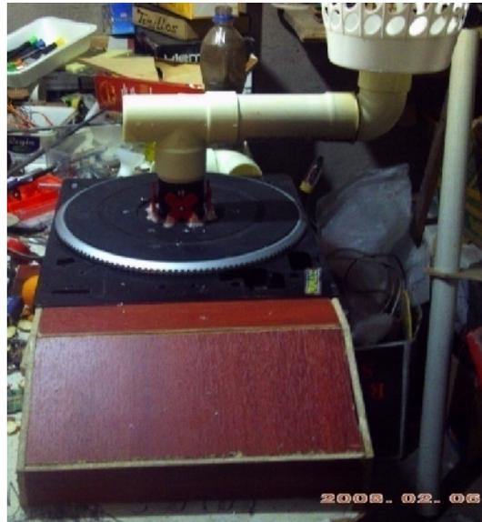
**Figura VI. 72. Conexión del servomotor en la base.**
