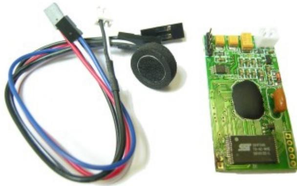
Figura III. 14. Módulo Vrobot.
