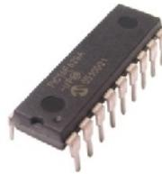
Figura VI. 28. Encapsulado del PIC 16f628
