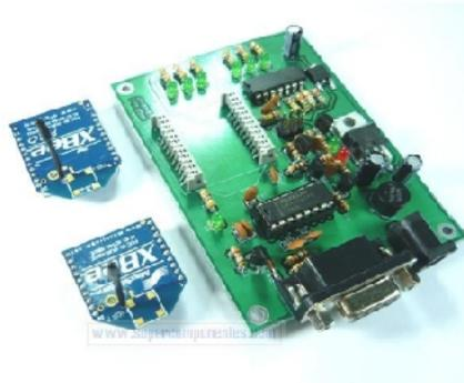
**Figura II. 5 Tarjeta de desarrollo XBee.**
