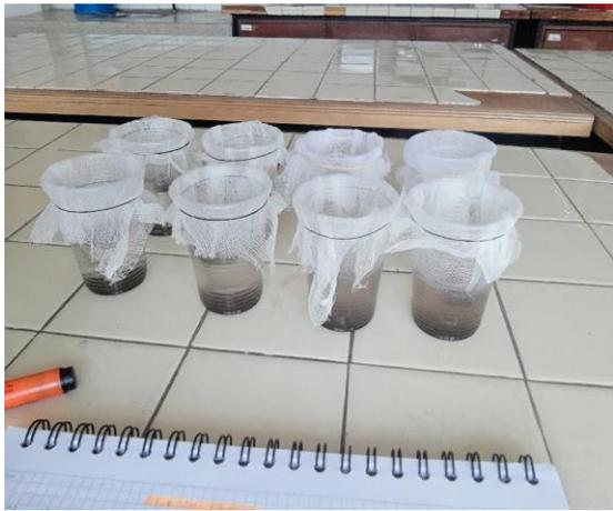
5. Proceso para determinar la estabilidad estructural del suelo
