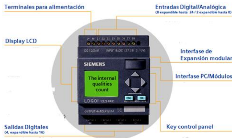
Figura IV.49 Partes del Módulo Lógico LOGO!
