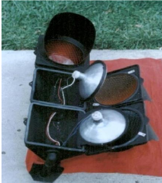
Ilustración 4-2: Cara del semáforo abierta Realizado por: Cisneros Ortiz, Ana, 2023.
