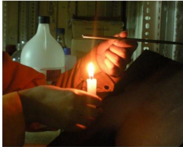
Figura V.108. Sensor de Temperatura a prueba calor
